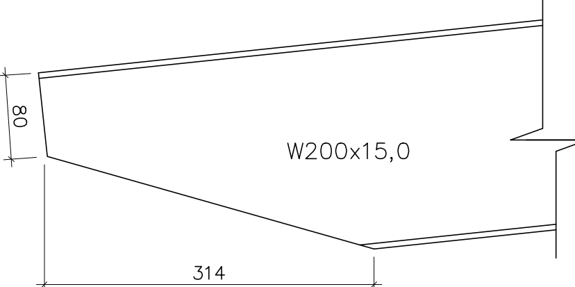
DETALHE 03: EXTREMIDADE VIGA PÓRTICO ESCALA: 1/5
